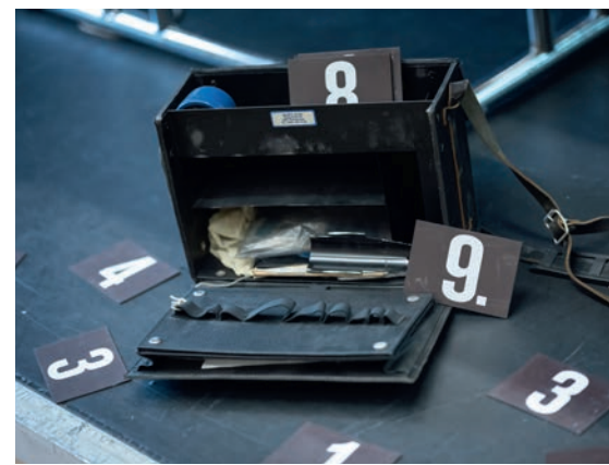
Spurensicherungskoffer: UV-Lampe, Rußpulver, DNA-Stäbchen, Pinsel, Nummerntafeln
